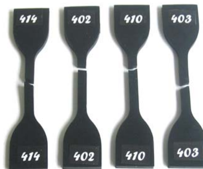
Bild 2: Zerstörte Materialprüfkörper Zug (hier FH München)
